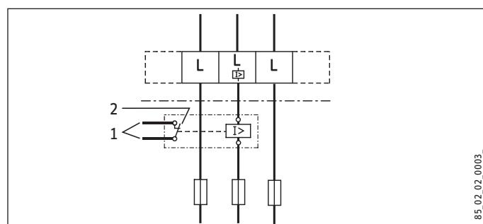
1 Câble de commande vers le contacteur du 2nd appareil (chauffage électrique à accumulation p. ex.).
