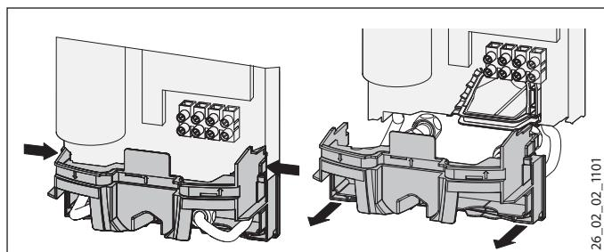
► Нажать на оба фиксатора и потянуть нижнюю часть задней стенки вперед.
