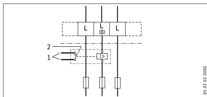
1 Řídicí obvod stykače 2. přístroje (například elektrické ohřívání zásobníku).
