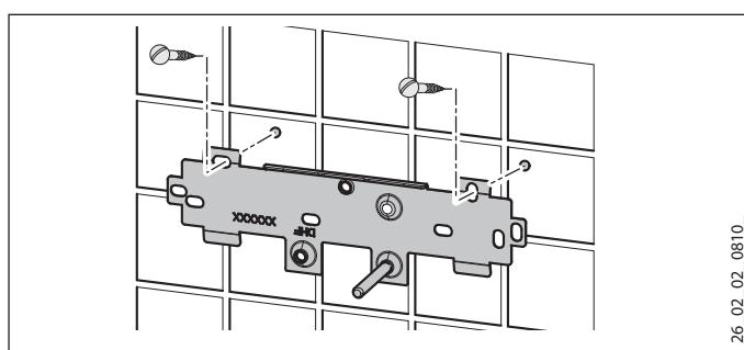
► Нанести на поверхность схему отверстий для сверления, (см. главу «Технические характеристики / Размеры и соединения»).
