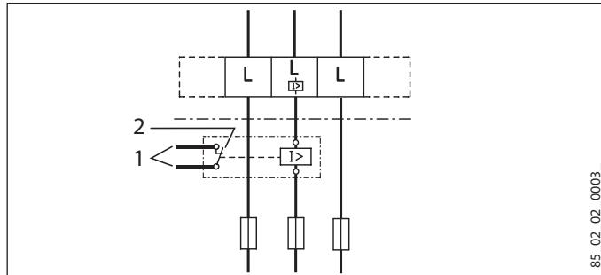
1 Линия цепи управления к контактору 2-го прибора (например, электрический бойлер).
