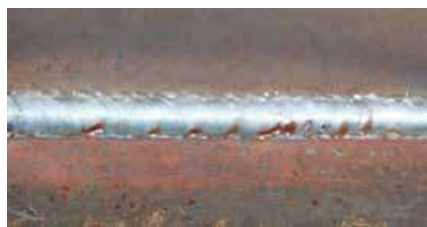
Рис 9.2. Сварной шов при максимальном значении индуктивности.
