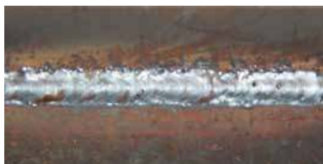
Рис 9.1. Сварной шов при минимальном значении индуктивности.
