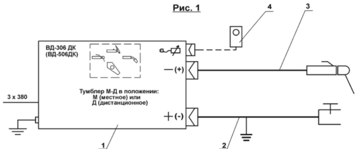
Схема включения сварочных выпрямителей ВД-306ДК и ВД-506ДК с блоком измерительным БИ-01 для сварки плавящимся покрытым электродом (ММА)
