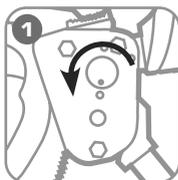
1 Разблокируйте рукоятки, повернув фиксатор разблокировки.
