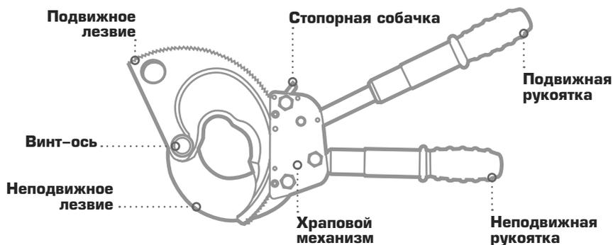
Ножницы секторные состоят из лезвий подвижного и неподвижного, храпового механизма, стопорной собачки и телескопических рукояток
