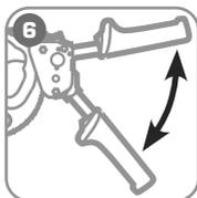
6 Разрежьте кабель, работая подвижной рукояткой. По окончании работы задвиньте рукоятки.
