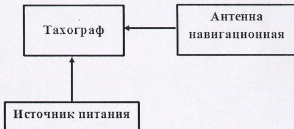
Рисунок 1 – Схема проведения измерений при проверке работоспособности
