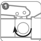
Поверните дросельный винт в положение «Закрыть»
